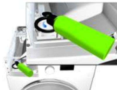
**4 Repérer env.100ml sur les 125ml du contenu de la 2e bouteille et les verser dans la partie arrière (petit trou).**
