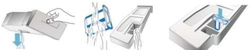
**3 Verser une bouteille complète de 125 ml de produit d'entretien dans la grande ouverture noire et ronde du sèche-linge et verser 1 litre d'eau très chaude par ex. avec un petit arrosoir (jusqu'à env. 60°C).**
